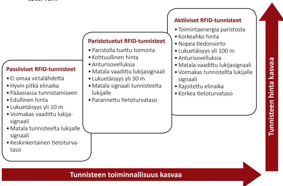
Kuva 6. RFID-tunnisteen kolme päätyyppiä ( http://www.rfidlab.fi/rfid-tekniiikan-perusteet )
